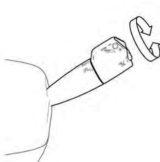
Sélectionnez le modes de transmission en pivotant le bouton extérieur du levier de vitesses. Il y a une position pour la conduite (**D**), le point mort (**N**) et la marche arrière (**R**) et stationnement (**P**) pour certains véhicules. Une rotation du bouton vers la position Park (**P**) ou Reverse (**R**) pendant que le véhicule se déplace vers l'arrière ne va pas changer le modes de transmission de ces sélections. L'affichage numérique indiquera le mode correspondant.
