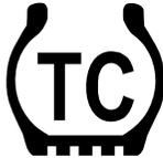
Surveille la vitesse des roues pour détecter un manque d'adhérence. Si une roue commence à patiner en raison d'une mauvaise adhérence, le système de traction asservie réduira la puissance du moteur et/ou serrera les freins pour tenter de rétablir l'adhérence.
