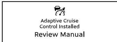
Cette indication au démarrage du véhicule signifie qu'il est équipé d'un régulateur de vitesse adaptatif (ACC) et d'un dispositif d'atténuation des collisions. Ces caractéristiques se combinent pour améliorer la sécurité des conducteurs et leur expérience de conduite. Lorsque le régulateur de vitesse est activé, le régulateur de vitesse adaptatif (ACC) accélère et ralentit le véhicule pour maintenir une distance choisie par rapport
