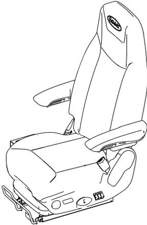
Les sièges de ce véhicule sont munis d'une commande qui verrouille la fonction d'isolement avant et arrière du siège. Verrouillé, aucun mouvement avant et arrière du siège n'est permis. Il est fixé de manière rigide et ne se déplacera que vers le haut et le bas selon les mouvements du véhicule.
