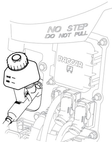
Inspectez visuellement le liquide d'embrayage du réservoir. Certaines canalisations sont moulées avec les lettres MIN pour indiquer le niveau de liquide minimum et MAX indiquant le niveau maximum recommandés pour un fonctionnement approprié. Assurez-vous de maintenir le niveau de liquide entre les repères MIN et MAX indiqués sur le réservoir en plastique. Si le niveau de liquide descend sous le repère MIN à
