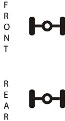
Les différentiels Tridrive sont munis de commandes de blocage du différentiel comportant deux commutateurs distincts. **FRONT (avant)** commande le pont milieu et **REAR (arrière)** commande le différentiel arrière central. Un véhicule équipé d'un différentiel Tridrive possède un commutateur de blocage du différentiel interponts.
